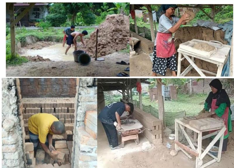
**Gambar 1.1** Proses Pencetakan Batu Bata
