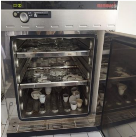
Pengovenan sampel lemak kuning telur pada suhu 105^{\circ}\text{C}
