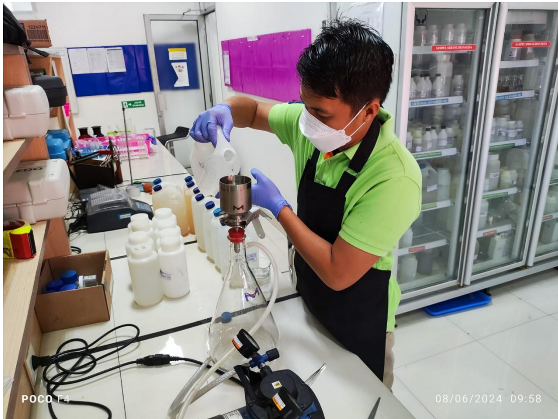
Gambar L.7. Penyaringan Sampel di Laboratorium dengan Filter 0,45 µm
