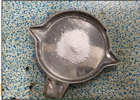
Gambar 1. 2 Serbuk Matos yang Digunakan Pada Pengujian.
