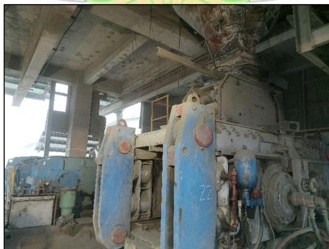
**Gambar 1.3** Mesin *Roller Press* di Pabrik Indarung IV
