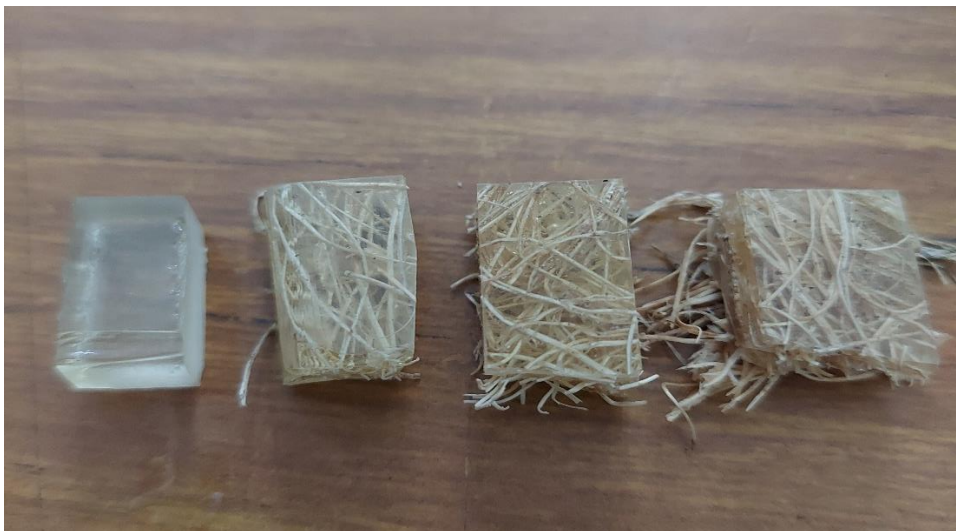
Gambar L. 6 Spesimen setelah preparasi untuk uji FTIR
