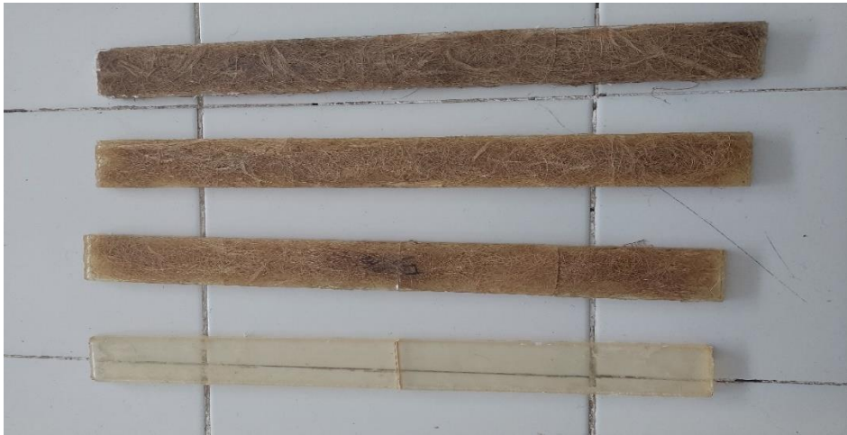
Gambar L. 1 Spesimen Hasil Uji Tarik
