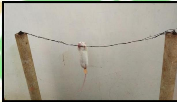
**Gambar 32. Pengujian Daya Tahan dengan Alat Gelantung**
