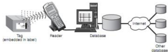
Gambar 2. 1 Sistem Kerja RFID [14]
