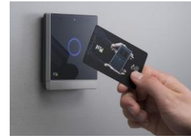
Gambar 2. 19 RFID Tidak Memerlukan Kontak Fisik [43]
