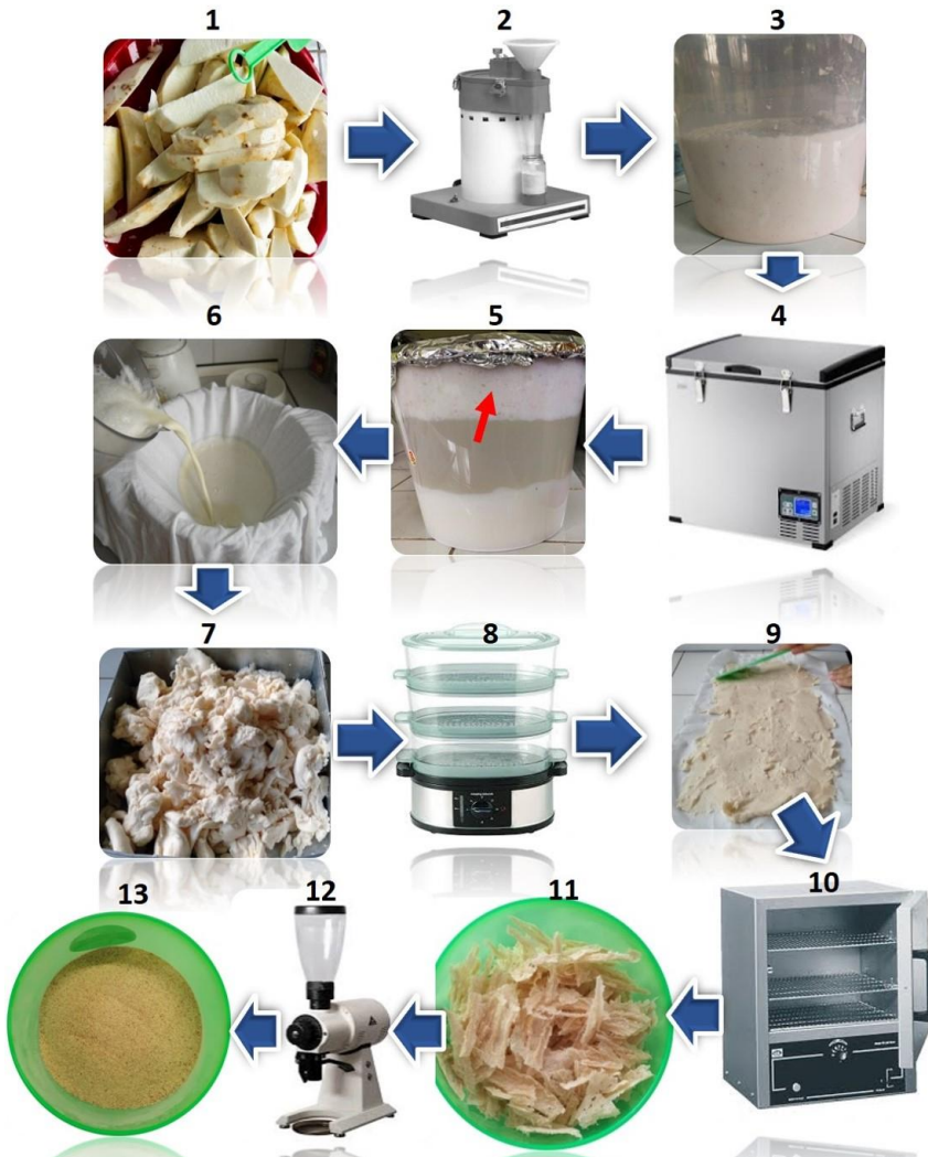
Gambar 1.2. Tahapan ekstraksi serat dari umbi dan rimpang (Santoso dan Maliza, 2020)
