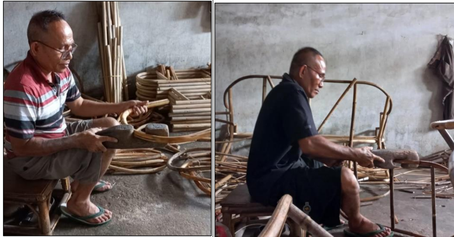
Gambar 1.3 Kondisi Pekerja saat Melakukan Pembengkokan Rangka
