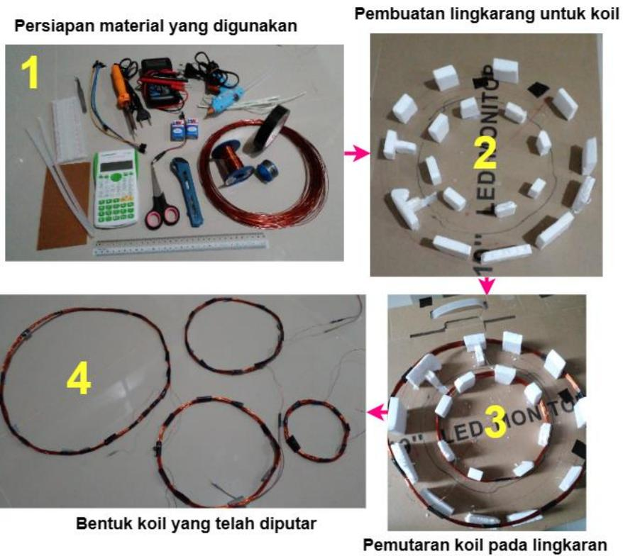
Gambar 4. 1 Proses tahap pembuatan sensor pendeteksi logam
