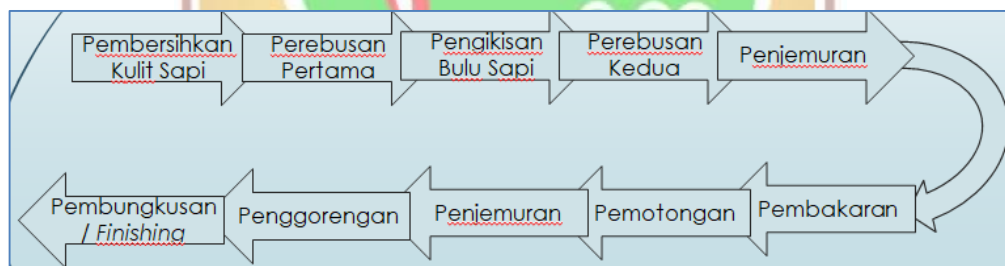
Gambar 1.1 Alur Produksi Kerupuk Kulit
