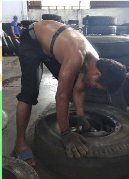
Gambar 4.3 Postur Tubuh Operator saat Memasukkan Ban Dalam Bagian Samping
