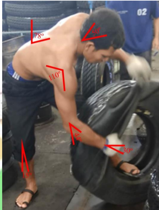
Gambar 4.15 Bentuk Sudut Postur Tubuh Memasang Envelope Bagian Bawah
