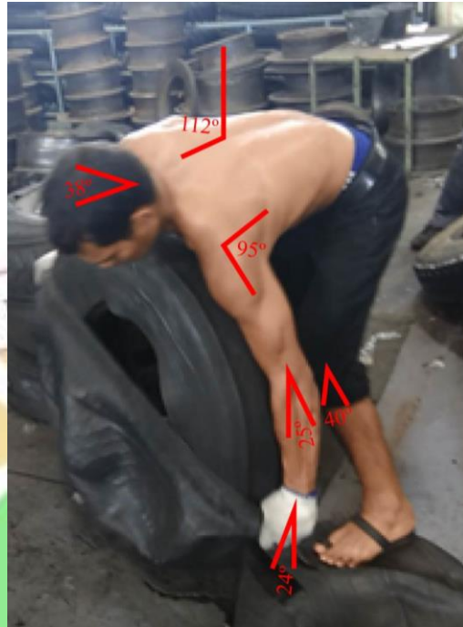
Gambar 4.13 Bentuk Sudut Postur Tubuh Memasang Envelope Bagian Atas
