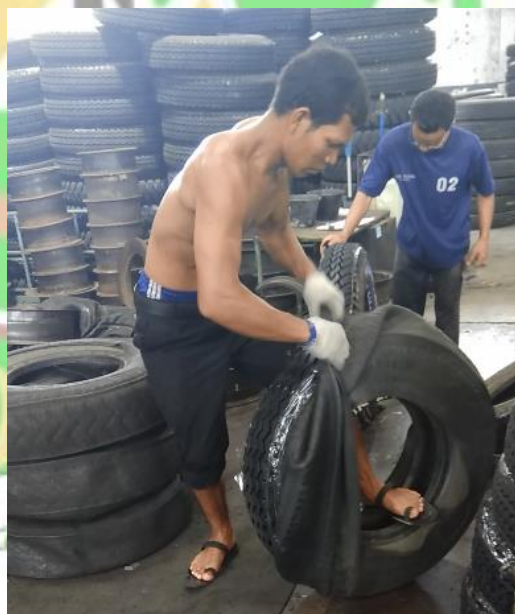
Gambar 4.5 Postur Tubuh Operator saat Memasang Envelope Bagian Samping
