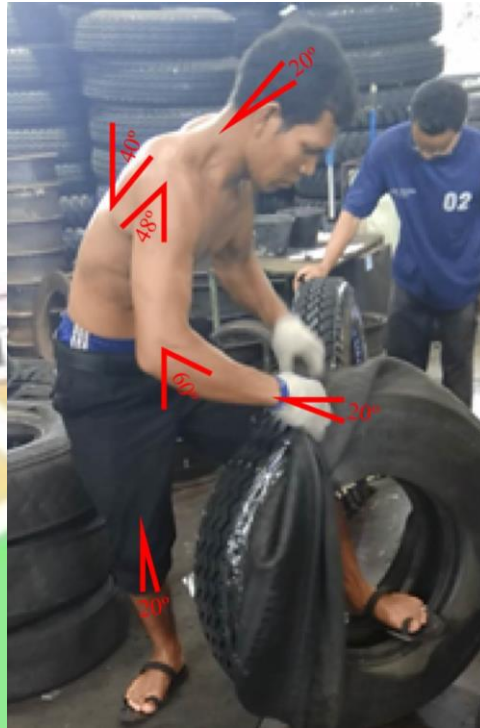
Gambar 4.14 Bentuk Sudut Postur Tubuh Memasang Envelope Bagian Samping
