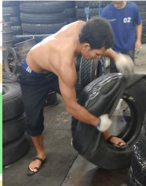
Gambar 4.6 Postur Tubuh Operator saat Memasang Envelope Bagian Bawah
