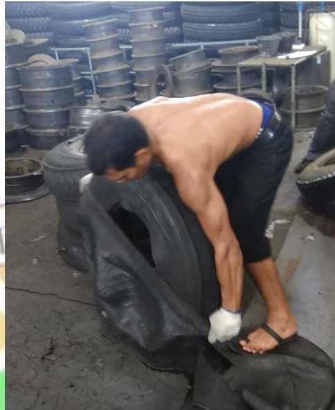
Gambar 4.4 Postur Tubuh Operator saat Memasang Envelope Bagian Atas
