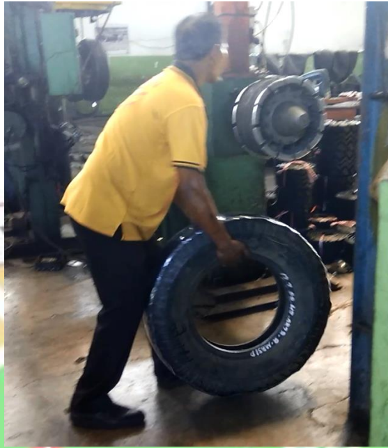
Gambar 4.7 Postur Tubuh Operator saat Mengangkat Ban ke Mesin Builder
