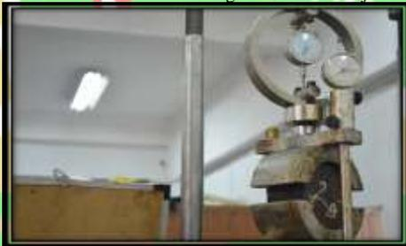
**Gambar 20** : Pengujian Stabilitas Dan Flow
