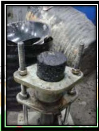
**Gambar 19** : Proses Pengeluaran Benda Uji
