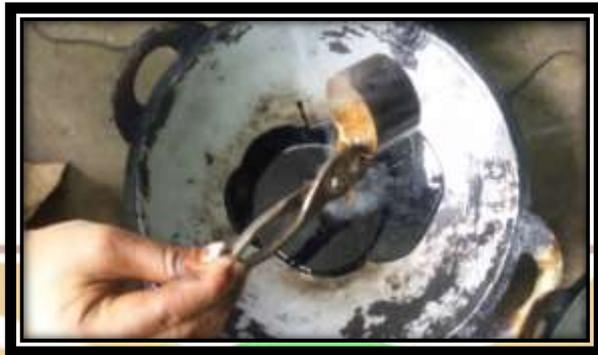
**Gambar 17 :** *Pencampuran Karet Gondorukem dengan aspal*
