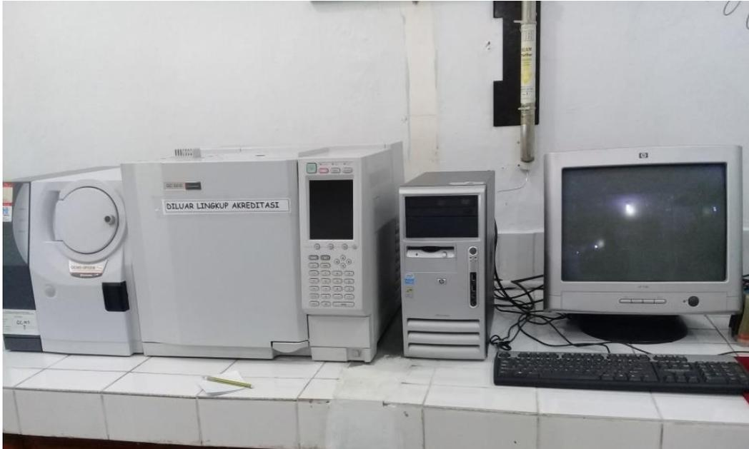
Gambar 38. Alat *Gas Chromatograph-Mass Spectrometer* yang digunakan untuk penentuan kandungan biopolimer P(3HB)
