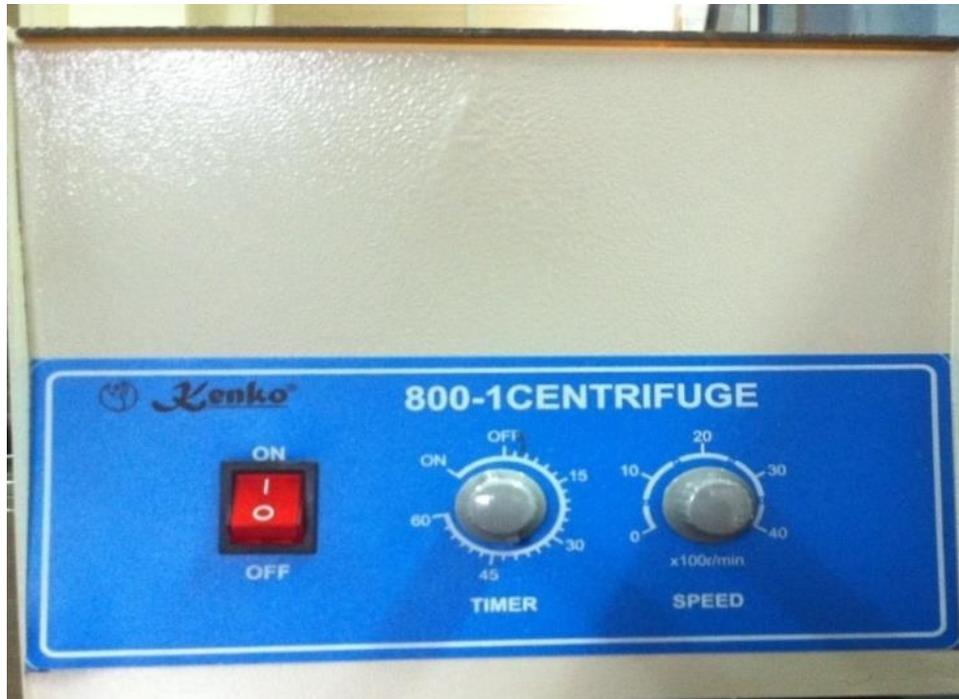
Gambar 40. Alat sentrifus yang digunakan dalam penelitian ini untuk memisahkan biomassa bakteri *B. cereus* dan supernatan setelah fermentasi selama 48 jam
