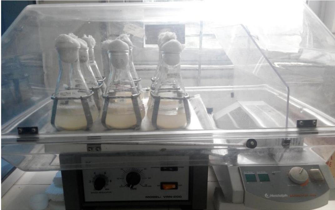
Gambar 39. Alat *Rotary Shaker Incubator* untuk fermentasi biopolimer P(3HB) yang digunakan dalam penelitian ini
