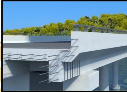
**Gambar 1. 2** Ilustrasi perkuatan geser dengan metode NSM pada balok jembatan.
