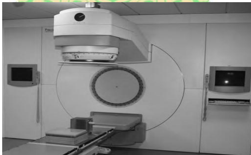
Gambar 2.4 Pesawat terapi Linac (Sumber : Mayles, 2007)
