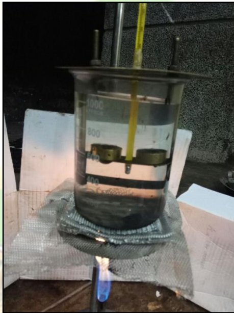
Gambar 5.3 Pengujian Titik Lembek Aspal
