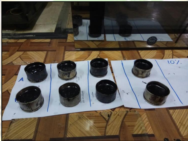
Gambar 5.1 Sampel yang telah dilakukan Uji Penetrasi Aspal
