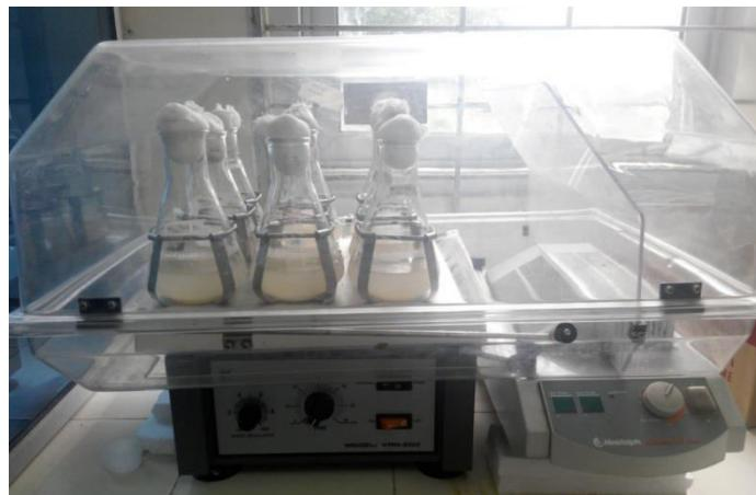
Gambar 29. Alat *Rotary Shaker Incubator* (K MODEL<sup>®</sup> : VRN-200)
