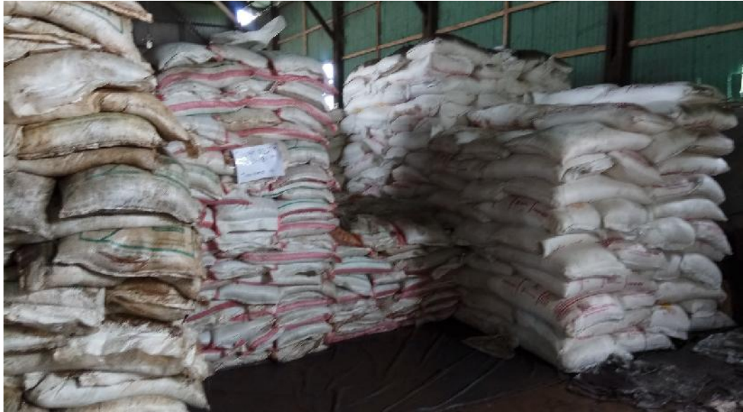
(a) Produk Jadi yang Diletakkan Belum Menggunakan Pallet
