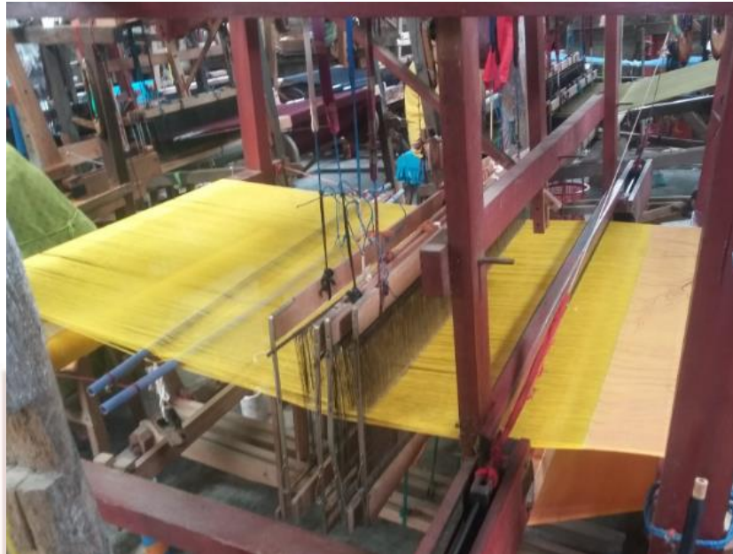
Gambar 1.1 Proses Menenun Menggunakan Alat Tenun Bukan Mesin (Industri Tenun Kubang H. Ridwan BY, 2017)
