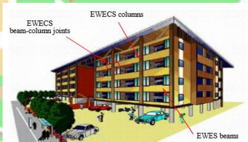
Gambar 1.2 Tampak Perspektif Struktur EWECS Untuk Gedung (Sumber: Fauzan et. al, 2005)
