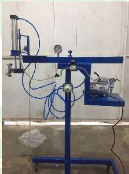
Gambar 4.1 Alat uji fluiditas metode vakum
