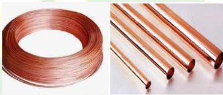
Gambar 3.5 Pipa Tembaga (a) sebelum (b) setelah diluruskan
