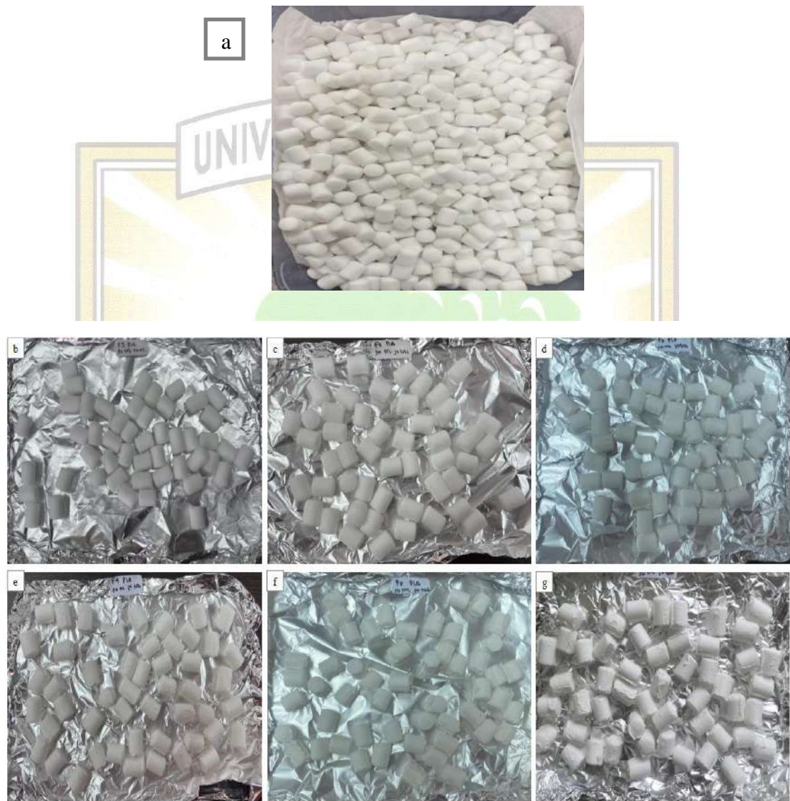
Gambar 25. (a) Hasil tablet urea tanpa penyalut, (b) tablet urea salut pada formula 1 dan (c) tablet urea salut pada formula 2, (d) tablet urea salut pada formula 3, (e) tablet urea salut pada formula 4 (f) tablet urea salut pada formula 5 (g) tablet urea salut pada formula 6.
