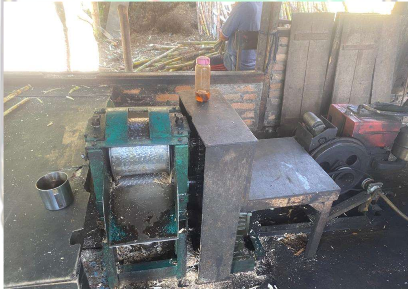
Gambar. 4.3 Mesin Diesel Kilang Tebu Sejak Tahun 2017.
