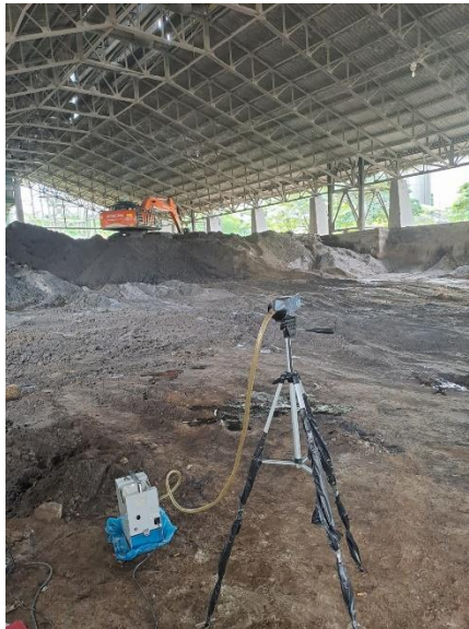
Gambar D.4 Pengambilan PM_{2.5} Menggunakan LVAS
