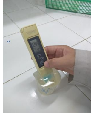
Gambar Pengukuran Parameter TDS Menggunakan TDS meter
