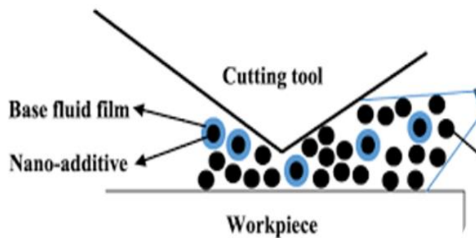
Gambar 1.1 Cairan pemotong diantara kontak permukaan benda kerja dan bidang aktif pahat
