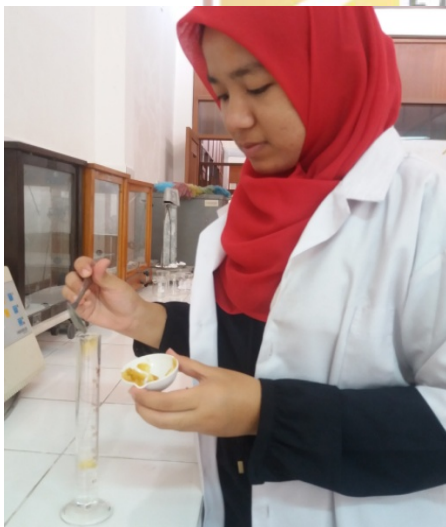
3. Masukkan sampel ke dalam beaker glass 25 ml
