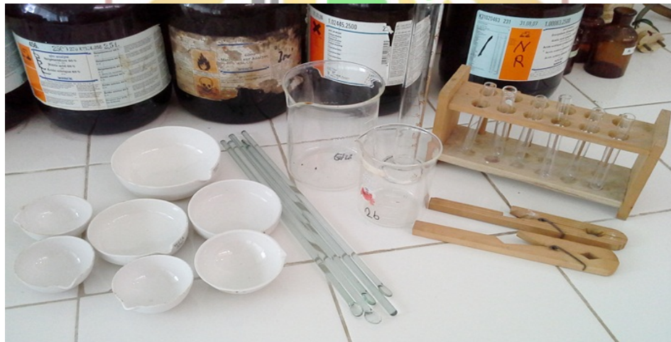
Cawan porselen, tabung reaksi, rak tabung reaksi, batang pengaduk, penjepit tabung reaksi, gelas ukur
