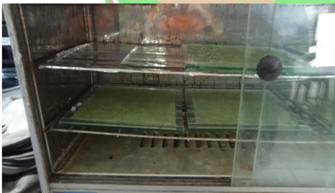
Proses pengeringan menggunakan cabinet dryer pada suhu 50°C selama 20 jam
