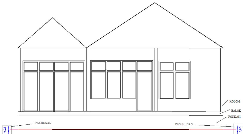
**Gambar 5.7** Penurunan Pada Kondisi Eksisting
