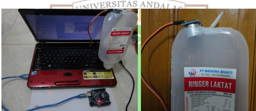
(a) (b) Gambar 4. 2 Skema Pengujian Sensor Ultrasonik
