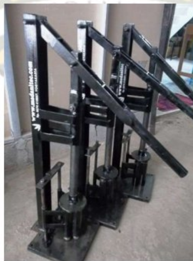
Gambar 1.2 Alat Pembuat Briket Sekam Padi Manual (Sumber: Tokopedia.com)
