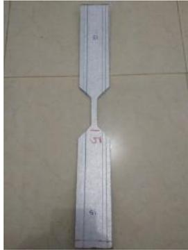
**Gambar 3.6 Model Uji Tarik Material Baja Ringan**
