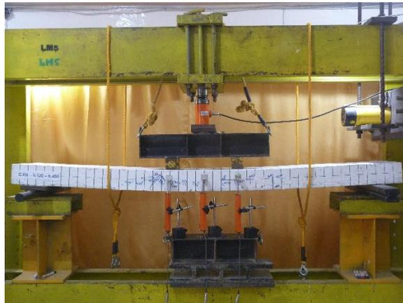
Gambar 35. Spesimen CS-2C setelah Pembebanan
