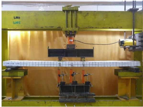
Gambar 28. Spesimen CS-2A sebelum Pembebanan
