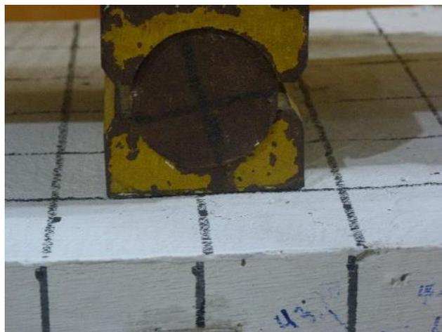
Gambar 24. Keruntuhan pada Spesimen CS-1B
