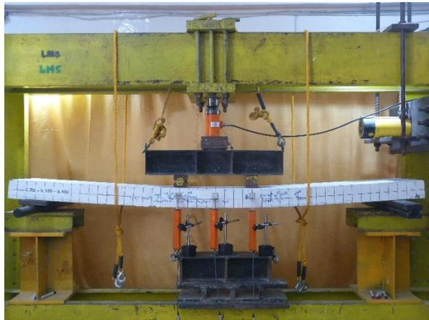
Gambar 32. Spesimen CS-2B setelah Pembebanan
