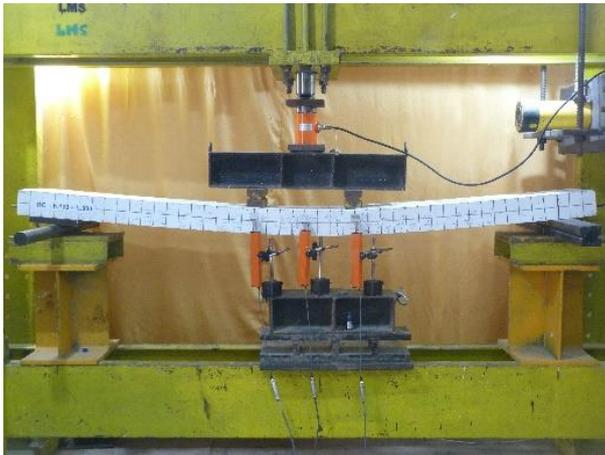
Gambar 5. Spesimen RC-1B setelah Pembebanan
