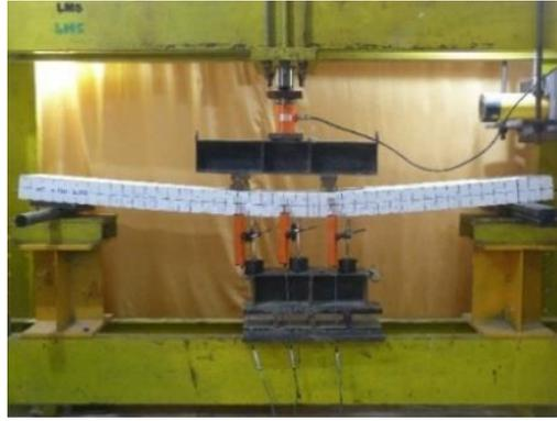
**Gambar 4.4 First Crack pada Spesimen RC-1B**
