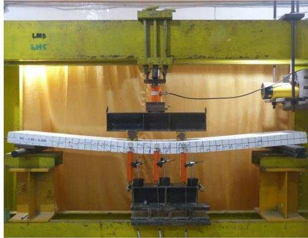
**Gambar 4.6 Proses pembebanan sampel RC-2A**
