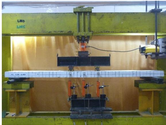
Gambar 10. Spesimen RC-2A sebelum Pembebanan
