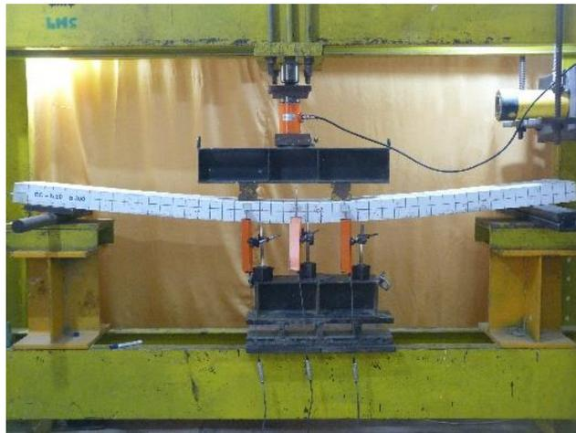
Gambar 2. Spesimen RC-1A setelah Pembebanan
