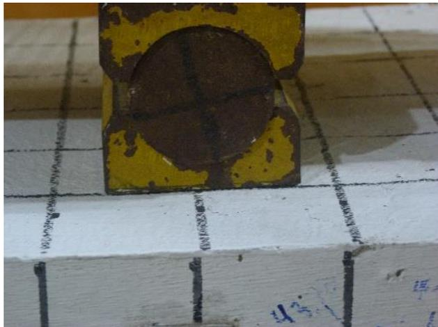
Gambar 24. Keruntuhan pada Spesimen CS-1B
