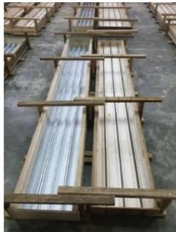
**Gambar 3.2 Model Benda Uji Menggunakan Baja Ringan profil C-lipped channel dan Tulangan D10**
