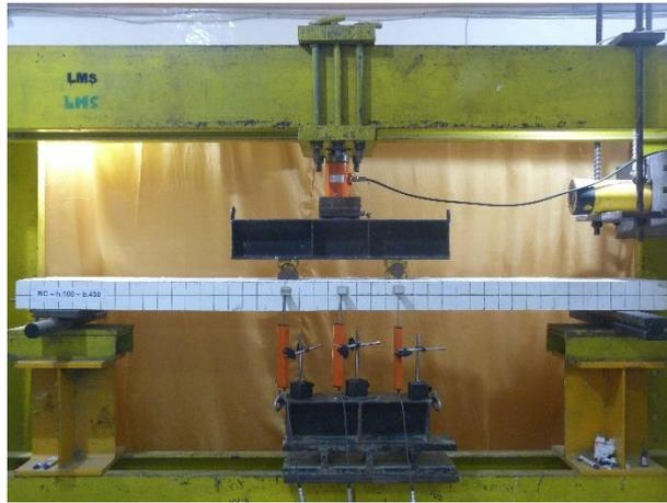
Gambar 13. Spesimen RC-2B sebelum Pembebanan
