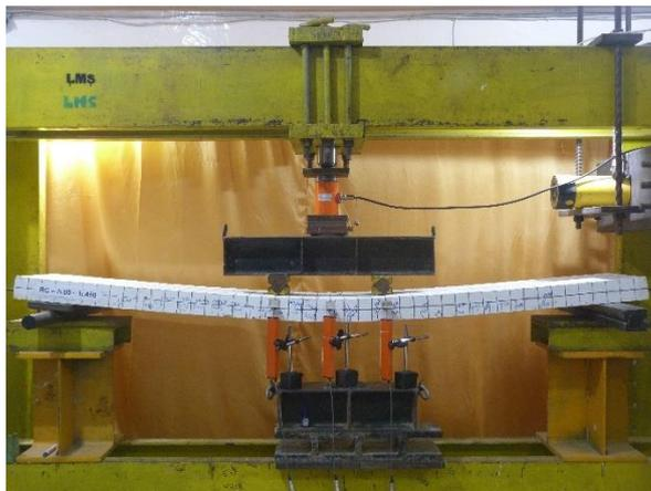
Gambar 11. Spesimen RC-2A setelah Pembebanan
