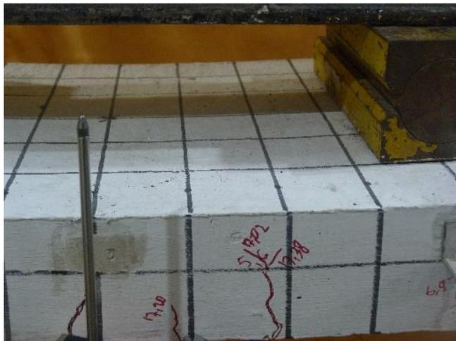
Gambar 3. Keruntuhan pada Spesimen RC-1A
