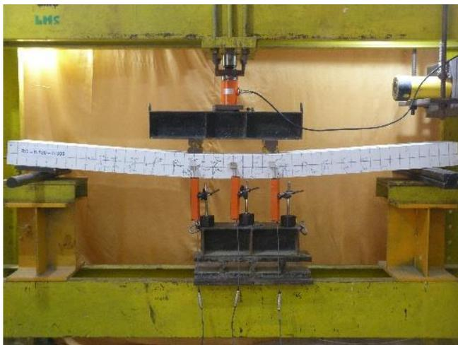
Gambar 8. Spesimen RC-1C setelah Pembebanan
