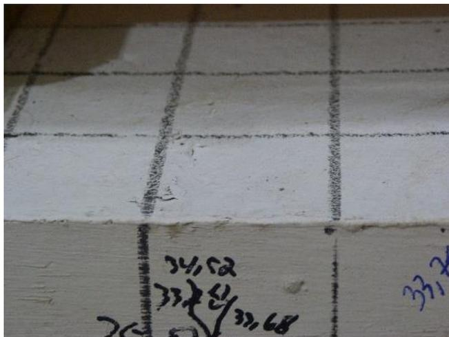
Gambar 9. Keruntuhan pada Spesimen RC-1C
