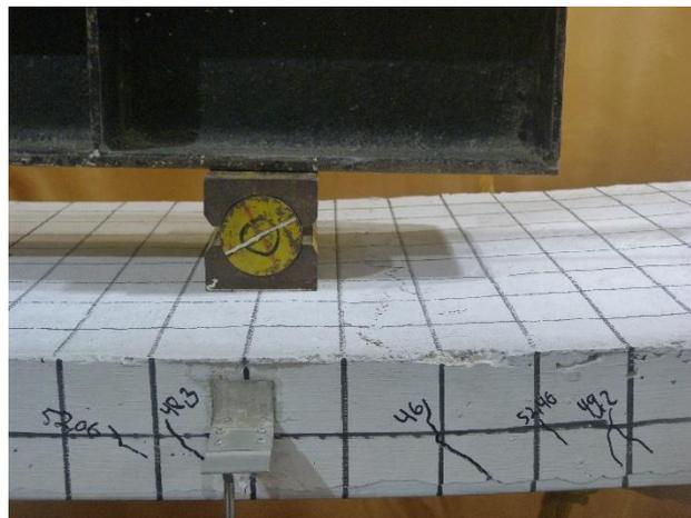
Gambar 30. Keruntuhan pada Spesimen CS-2A
