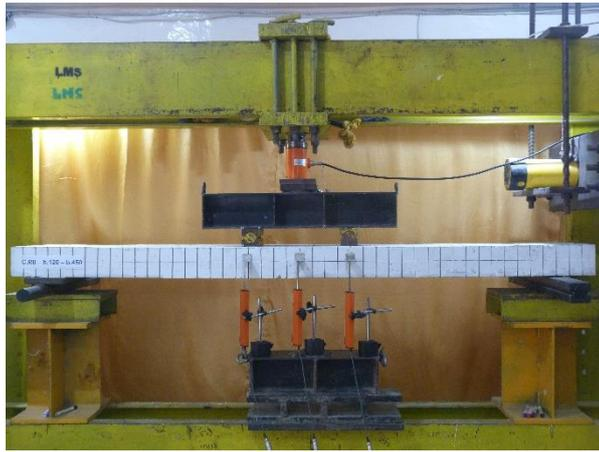
Gambar 34. Spesimen CS-2C sebelum Pembebanan
