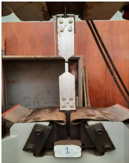
Gambar 20. Pengujian Kuat Tarik Baja Ringan
