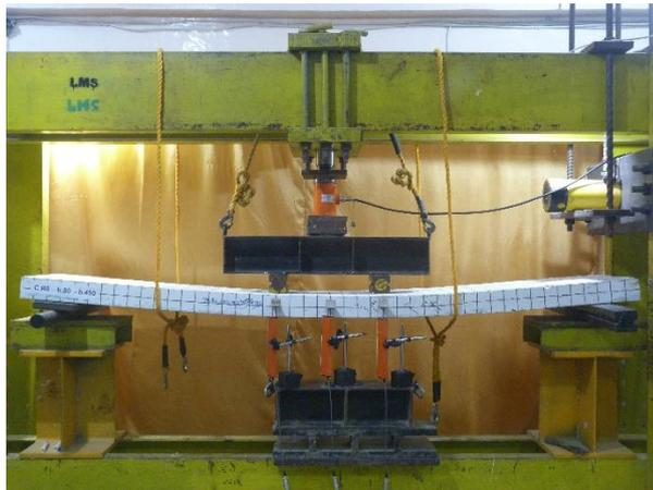
Gambar 29. Spesimen CS-2A setelah Pembebanan
