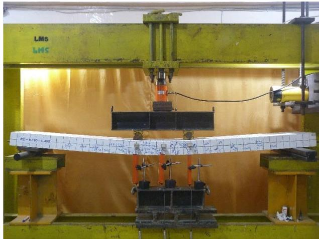
Gambar 14. Spesimen RC-2B setelah Pembebanan
