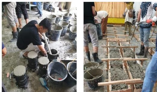
**Gambar 3.3 Penggunaan Alat vibrator dan Persiapan Sampel Uji Tekan**
