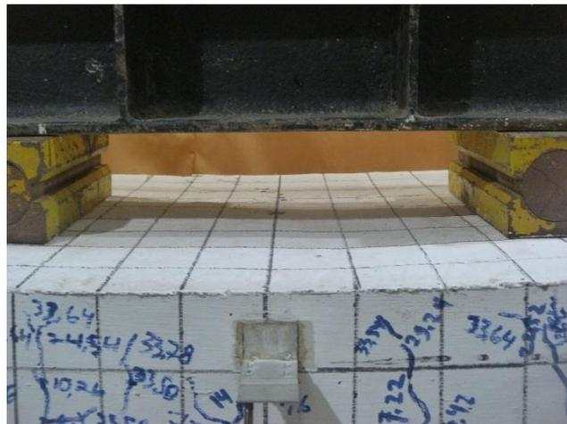
Gambar 15. Keruntuhan pada Spesimen RC-2B
