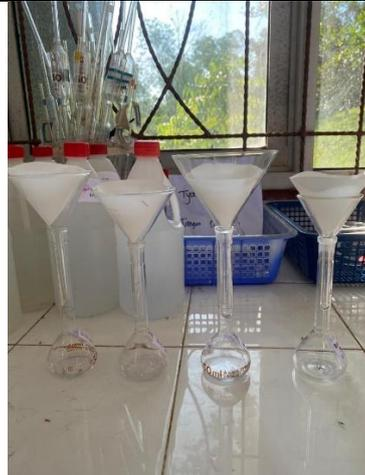
**Gambar D.6 Penyaringan dengan *Filter Whatman* No.42**
