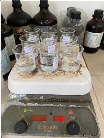
**Gambar D.5 Sampel dipanaskan pada suhu 150°C**
