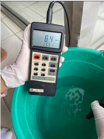
**Gambar D.3 Pengukuran DO dan Suhu Air**
