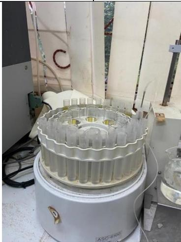
**Gambar D.9 Analisis Konsentrasi Logam Berat dengan ICP-AES**
