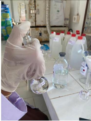
**Gambar D.7 Sampel dilarutkan dengan Aquabidest hingga 50 mL**
