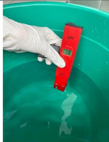
**Gambar D.2 Pengukuran pH Air**
