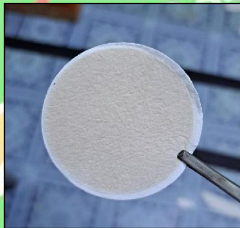
Gambar 4.11 Filter Fiber Glass Setelah Uji WBT
