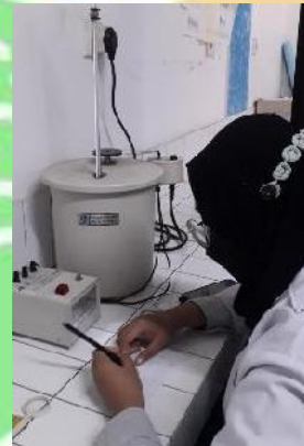
Gambar J.10 Pengujian Nilai Kalor Briket Arang
