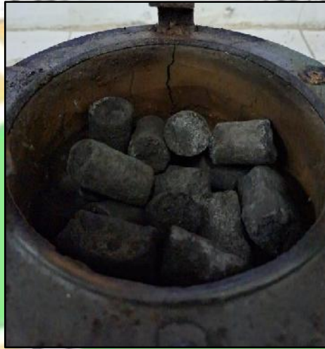
Gambar 4.2 Briket Arang Memenuhi Ruang Pembakaran Kompor Biomassa
