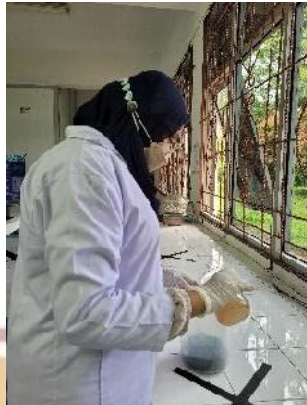
Gambar J.7 Pencampuran Bahan Briket Arang dengan Perekat Kanji
