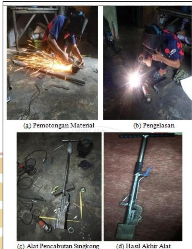
**Gambar 4.16** Proses Pembuatan Prototipe
