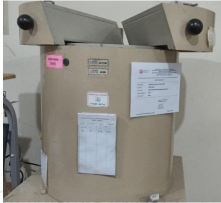
Gambar 3. 1 Spektrometer Gamma detektor HPGe seri GEM-F5930-1
