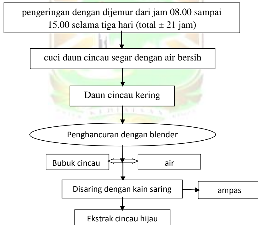
Gambar 2. Proses pembuatan bubuk daun cincou hijau rambat modifikasi (Koswara, 2008)
