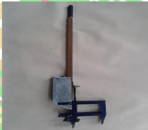
Gambar 9. Tugal Benih Kedelai Semi Mekanis Tipe Geser Sumber : Arifin, (2016)
