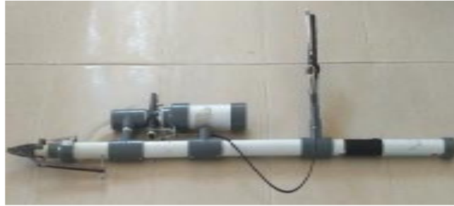
Gambar 8. Tugal Semi-Mekanis Dengan Sistem Penjatah Sumber : Feby, (2018)
