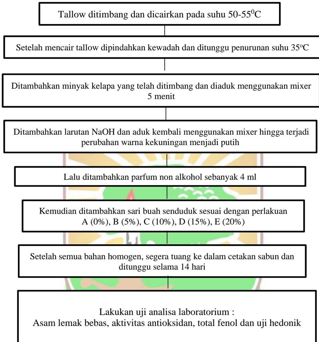
**Gambar 5.** Diagram Alir Pembuatan Sabun Modifikasi Metode Kamikaze (2002)
