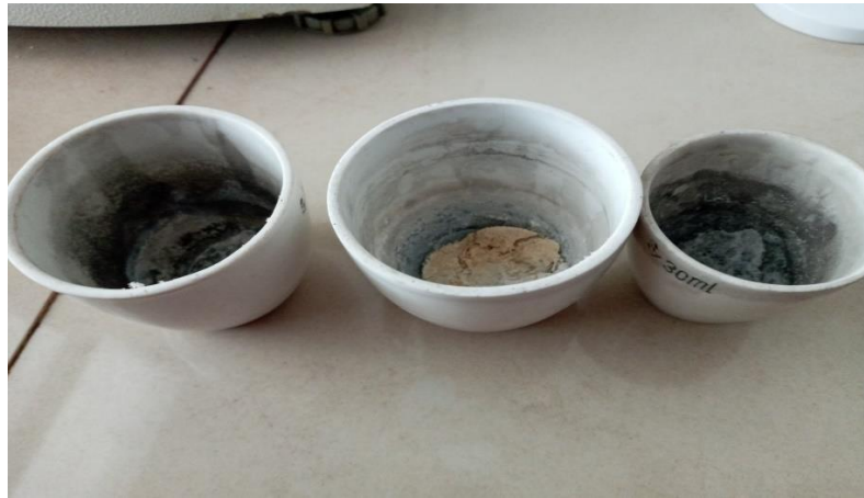
Gambar 19. Pengujian kadar abu ekstrak etanol daun sungkai
