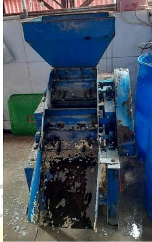
**Gambar 1.1** Permukaan Mesin Berkarat, Tidak Rata, dan Mengelupas
