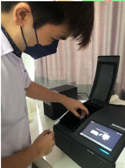
Sampel dimasukkan ke dalam spektrofotometer merek Shimadzu™ UV-1900i Spectrophotometer produksi Shimadzu Corporation, Jepang.
