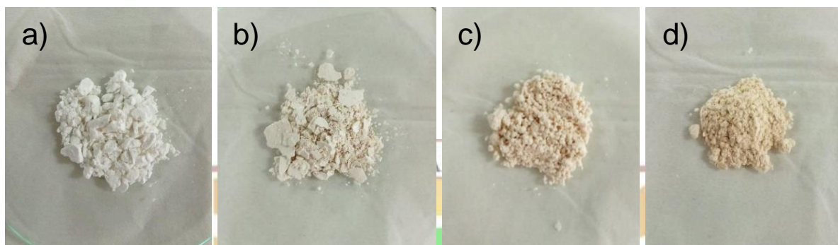
Gambar 4.3 Serbuk \text{Ce}_2(\text{CO}_3)_3 hasil sintesis dengan penambahan variasi konsentrasi EDG a) tanpa EDG, b) EDG 1% v/v, c) EDG 1,5% v/v, d) EDG 2% v/v
