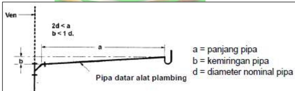
**Gambar 2.31 Jarak Maksimum Ven dari Perangkat Alat Plambing**
