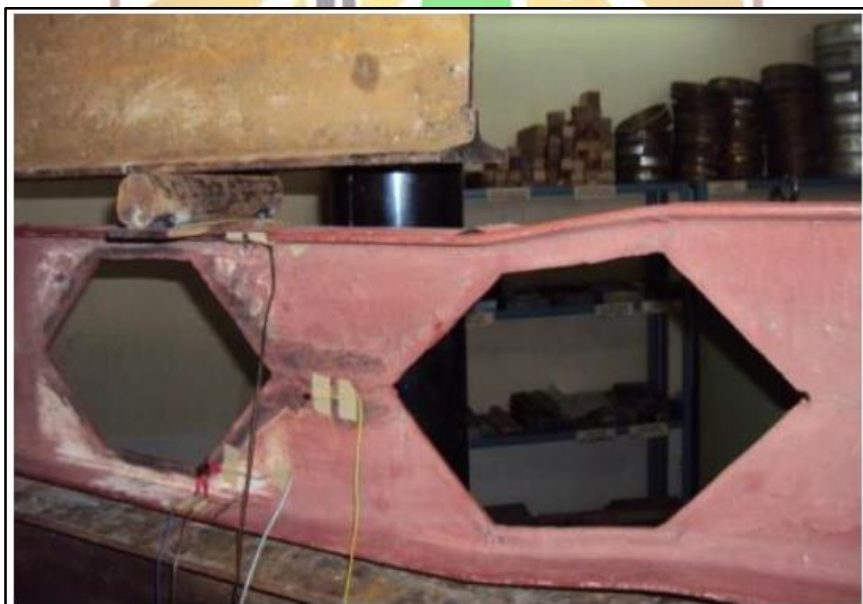
Gambar 1. 3 Contoh Kegagalan pada Balok Kastela
