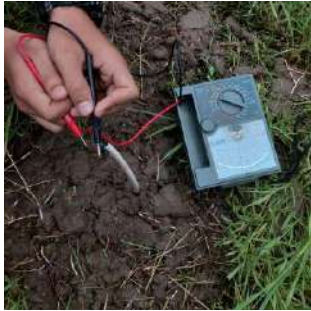
Pengukuran Resistansi Tanah (ohmmeter)
