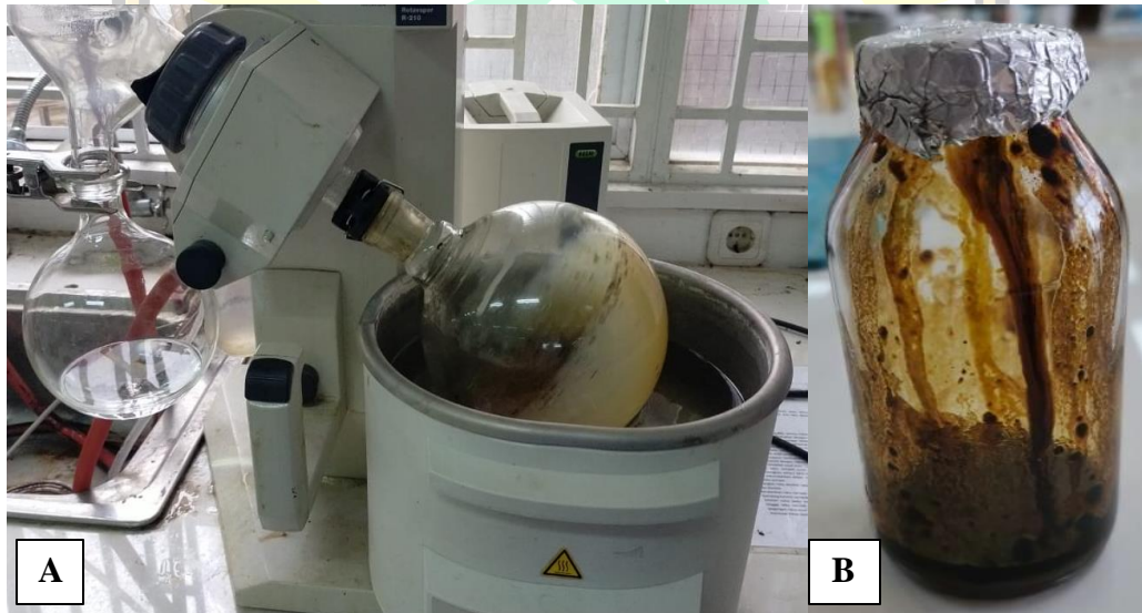
Gambar 11. Proses pengentalan ekstrak daun kersen menggunakan rotary evaporator (A) dan ekstrak kental daun kersen (B).
