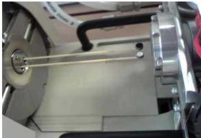
Gambar III.3 Proses memasukkan bahan kedalam alat TGA.
